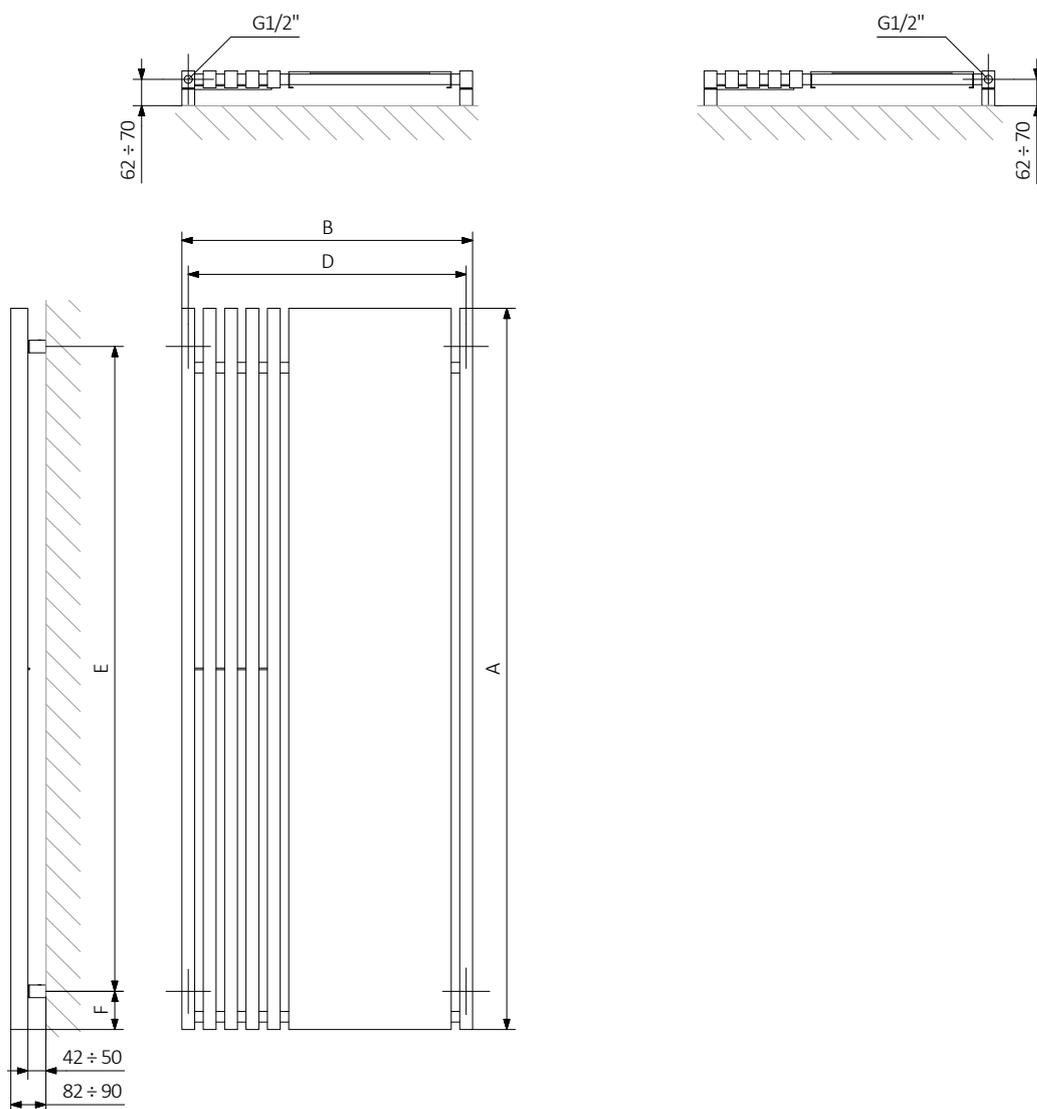
A – hauteur B – largeur C1-C5 – écartement des raccordements D – écartement des consoles en horizontal
